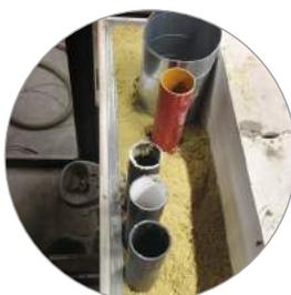
Installationsschacht mit brennbaren und nichtbrennbaren Abwassersystemen
